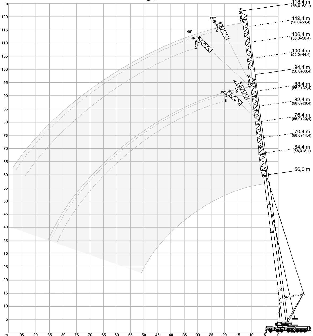
**LF LIFTING CAPACITIES · TRAGFÄHIGKEITEN · CAPACITÉS DE LEVAGE · PORTATE · CAPACIDADES DE CARGA**
