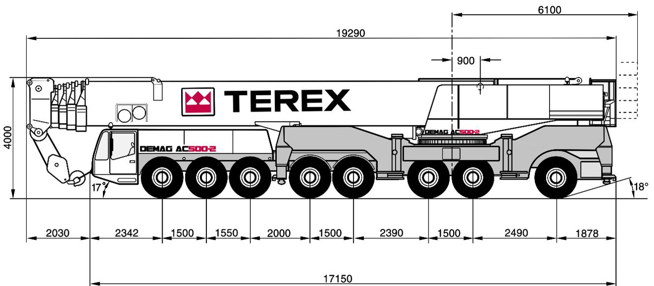
**DIMENSIONS · ABMESSUNGEN · ENCOMBREMENT · DIMENSIONI · DIMENSIONES**
