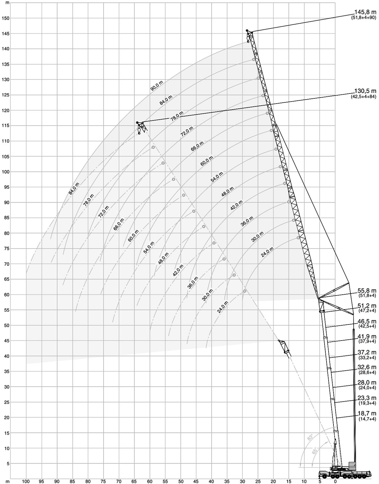
**WIHI LIFTING CAPACITIES · TRAGFÄHIGKEITEN · CAPACITÉS DE LEVAGE · PORTATE · CAPACIDADES DE CARGA HA 83° - 65°**
